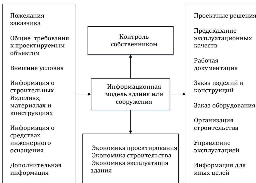
Рисунок 1. Структура информационной модели зданий или сооружений АПК.
